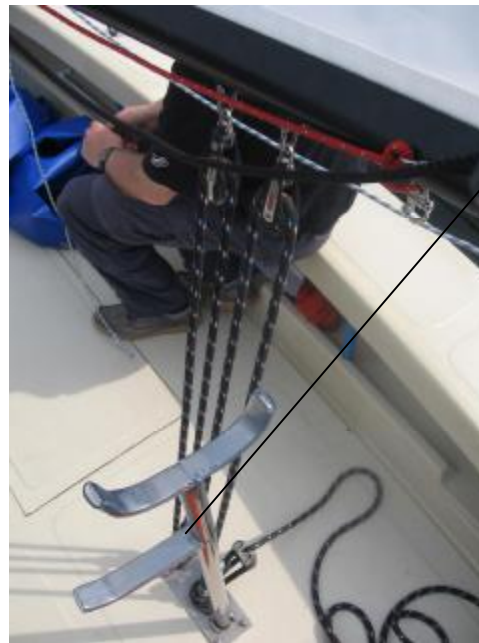
Während des Segelns unter die hintere Sitzbank. Dort sind Klemmen befestigt
